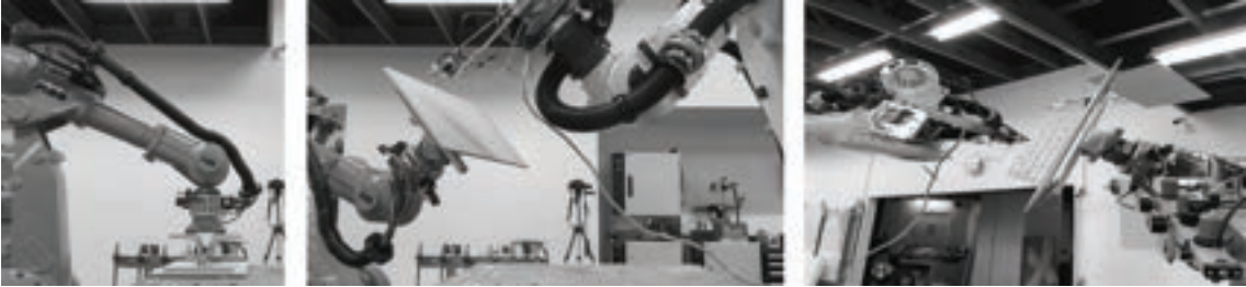
..... Figura 7. Colaboración de dos robots con herramientas de extrusión y agarre (2018). Elaboración propia.
